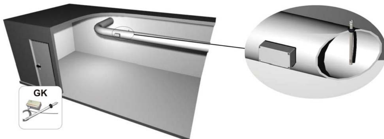
Figure 4 : Disposition des détecteurs de gaine
